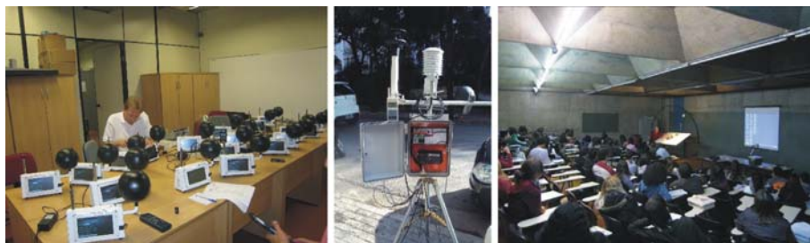
À esquerda, lote de 20 confortímetros sendo testados pelo fabricante e pelo técnico no laboratório; ao centro, estação meteorológica Campbell em trabalho de campo e, à direita, aula de geometria da insolação com o heliodon projetado e construído na FAUUSP, pelo LABAUT/LAME, por uma aluna de graduação, e para os alunos da graduação
