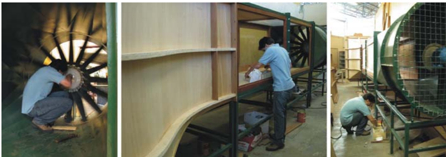
10 Túnel de vento de camada limite atmosférica projetado e construído por um aluno de graduação, em projeto de iniciação científica LABAUT/LAME
