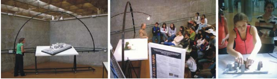
8 À esquerda, heliodon projetado e construído por aluna de iniciação científica no LABAUT/LAME, em uso no AI; ao centro, aula prática de geometria da insolação para os alunos do 1º ano no AI e, à direita, uso do heliodon em trabalhos dos alunos
