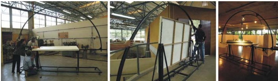
9 À esquerda, heliodon em construção no LAME, ao centro, já pronto, fechado em posição de transporte e, à direita, em exposição de trabalhos do Departamento de Tecnologia, no piso do museu, na FAUUSP, em 2006
